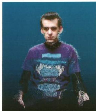
Rysunek 5: Przykład rejestracji modelu 3W z wykorzystaniem trzech kamer głębi Microsoft Kinect v2.
