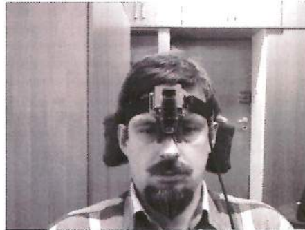
Rysunek 9: Osoba badana z wykorzystaniem okulografu JazzNovo firmy Ober Consulting [H7].
